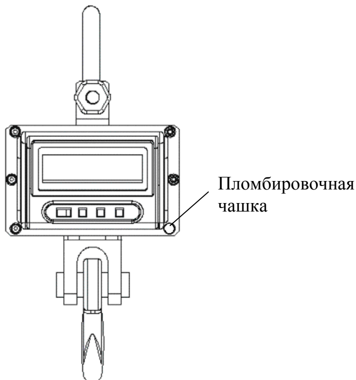
Рис. 16.1 - Место нанесения отпечатка поверительного клейма
